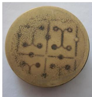
FIGURE 2.24 – Dépôt sur la cathode (électrode en laiton) observé à l'issue de collage anodique à forts champs électriques.
