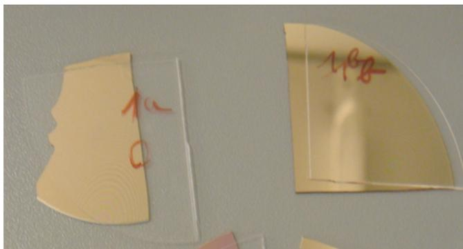
FIGURE 2.28 – Influence de la température sur le collage anodique. A gauche, l'auréole rouge correspond à la toute petite zone collée qui a été repérée juste après le collage à 350°C, à droite, il n'y pas collage à 215°C
