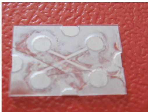
FIGURE 2.43 – Photo du dispositif Pyrex -  $\text{Si}_3\text{N}_4$  - a-Si / Pyrex après les expériences électriques.
