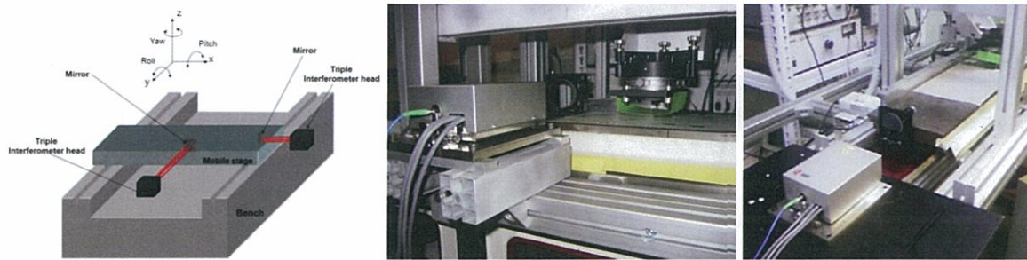
Figure 4-5: Mesure interférométrique des performances mécaniques du banc. Gauche: Schéma du montage. Centre: Photo prise lors des mesures dans la direction perpendiculaire au déplacement. Droite: Mesures du lacet et du tangage.
