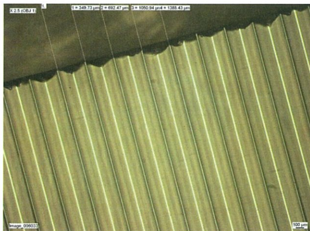
Figure 4-27: Image prise au microscope optique des microlentilles cylindriques grossie 2,5 fois.
