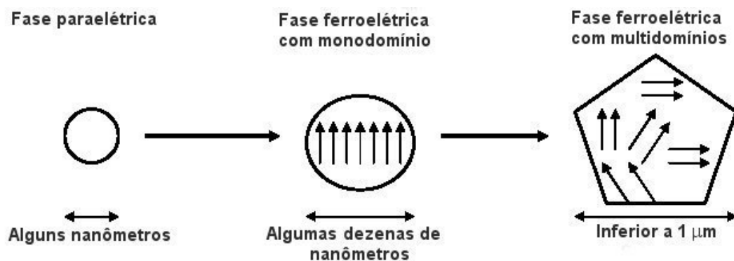
Figura 12 - Descrição esquemática do efeito do tamanho de grão na estrutura de domínio ferroelétrica. Adaptado da referência (37).
