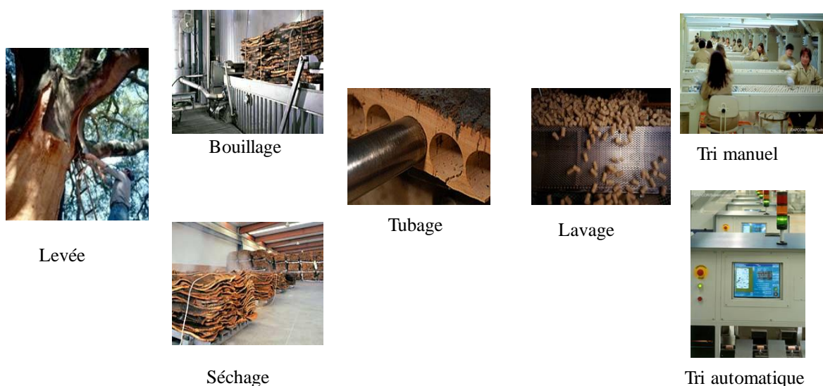
Figure I.6 : Etapes de la fabrication des bouchons de liège, d'après la photothèque d'Amorim et APCOR.
