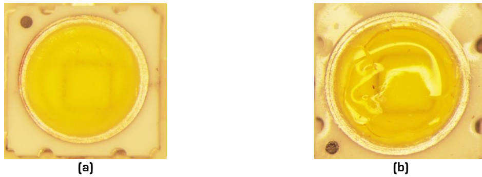
Figure IV - 30 Image au microscope optique de la vue de dessus du polymère d'enrobage d'une DEL blanche : (a) Avant vieillissement, (b) Après vieillissement
