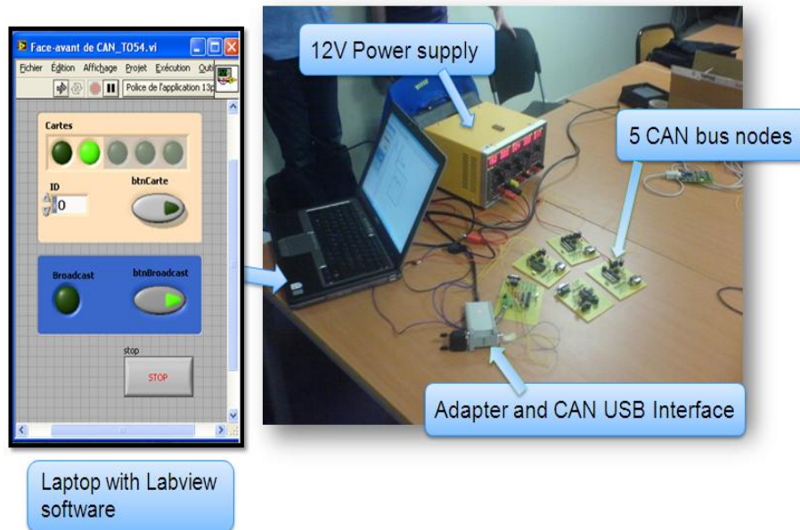
Figure II.6 – Test de fonctionnement sur table du bus CAN ouvert réalisé
