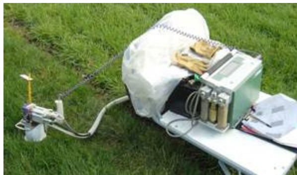
Figure 22 : Photographie de la LICOR 6400 à droite et de la chambre de mesure de la respiration du sol à gauche.
