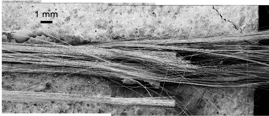
Figure 5.5. Fil OC1W après essai d'arrachement – glissement des filaments non ancrés au cours de la phase résiduelle (les filaments sont extraits vers la gauche).
