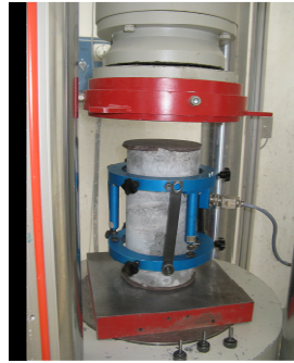
Figure 2.48. Essai extensométrique sur éprouvette cylindrique 16*32 cm.
