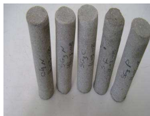
Figure 3.29. Carottage réalisé dans des éprouvettes de mortier contenant un fil multi-filamentaire enrobé.
