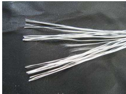
Figure 4.10. Filaments extraits de la matrice au cours de l'arrachement, OC1 D, L_e = 3 cm.
