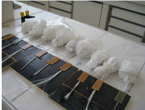
Figure 4.2. Protection des éprouvettes de la dessiccation lors de la préparation des éprouvettes d'arrachement.
