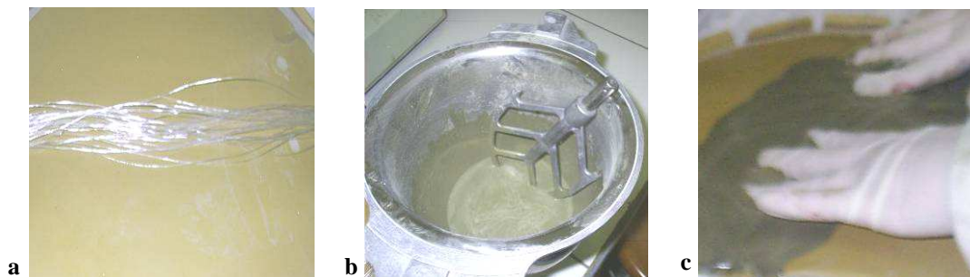
Figure 2.40. Pré-imprégnation du fil par le coulis de ciment. a- fil à l'état initial ; b- préparation du coulis ; c- trempage manuel du fil dans le coulis.
