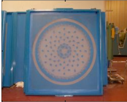
Figure 3.15. Cadre métallique pour l'impression.
