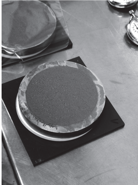
Figure 1.6. Essai de rétention d'eau sur mortier frais.
