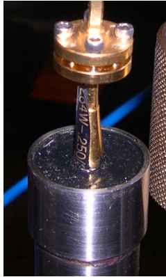
FIGURE 7.6 – Etanchéité de l'insert micro-onde par mise en place de Stycast entre les guides d'onde et le tube enveloppe en acier inoxydable.
