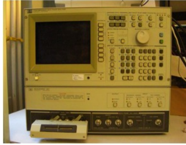
Figure 2.17 Impédancemètre HP4194A utilisé pour les mesures électriques
