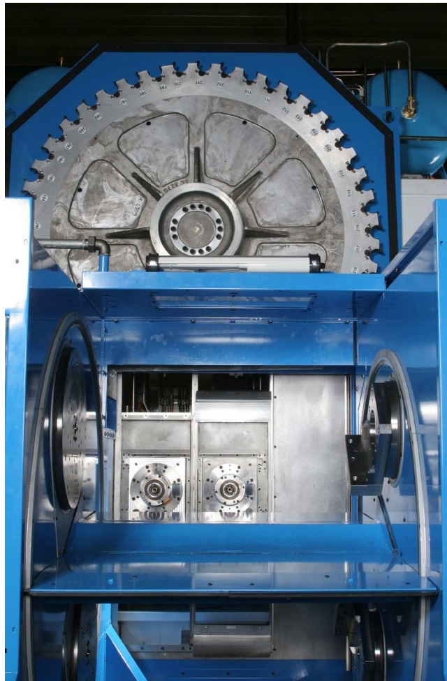
Figure 3.2 Centre d'usinage Meteor ML (PCI/SCEMM)
