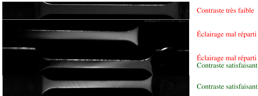
FIGURE 4.14: Variation de la qualité de l'acquisition des images pour des mesures optiques directes sur surfaces polies.
