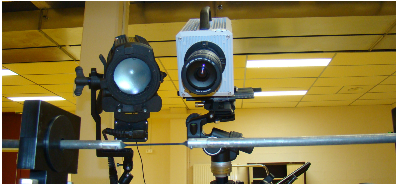
FIGURE 3.7: Configuration de la caméra rapide et de l'éclairage pour un essai de traction dynamique aux barres de Hopkinson.
