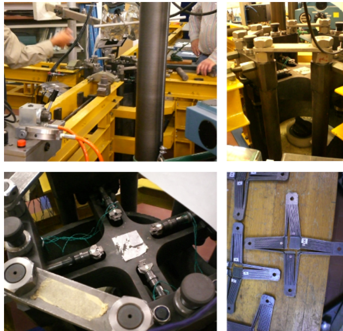
FIGURE 1.14: Dispositif de traction dynamique biaxial du JRC d'Ispra.
