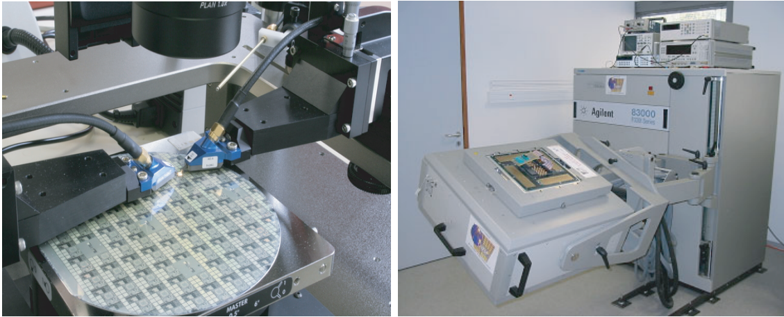
Figure 2.4 – Équipement de test automatique (ATE).
