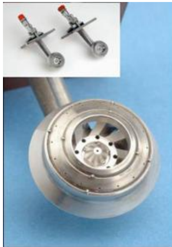
Figure 126 : Exemple de système d'injection multipoints. Snecma.
