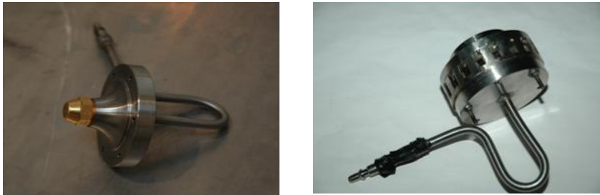
Figure 27 : (a) Photographie de l'injecteur sur son porte-injecteur. (b) Photographie de l'assemblage du système d'injection
