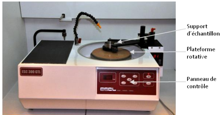
Figure 2.1. Polisseuse mécanique permettant de préparer les échantillons.
