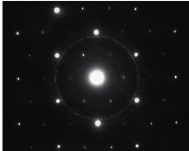
Figure 1.11 : Exemple de diagramme de diffraction obtenu avec la technique NBED pour un échantillon de siliciure de manganèse.
