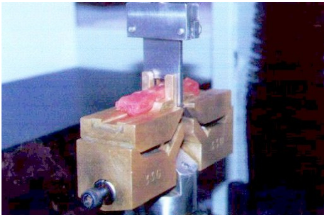
Figure B-4. Cellule de cisaillement installée sur une machine d'essais Instron 4501.
