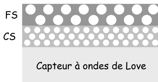
FIGURE 2.17 – Schéma du capteur bicouche CS-FS
