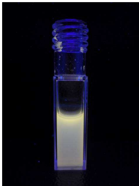
Figure 4.15. Nanoparticules de \text{ZnO-Cs}_2[\text{Mo}_6\text{Br}_{14}]\text{@SiO}_2 dispersées dans de l'eau distillée et photographiées sous une lampe UV avec une longueur d'onde d'excitation de 365 nm.
