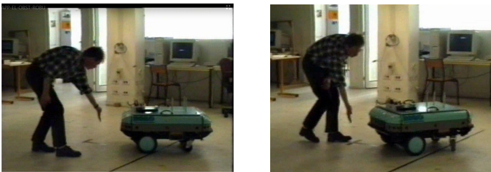
FIGURE 3.6 – Apprentissage par interaction sensorielle avec le Robuter en sollicitant ses capteurs à ultrasons (Bourdon et Henaff, 1997).
