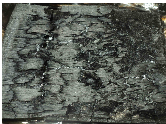
Figure 94 : photo du résidu final à la fin du test en cône calorimètre à 50 \text{ kW.m}^{-2}
