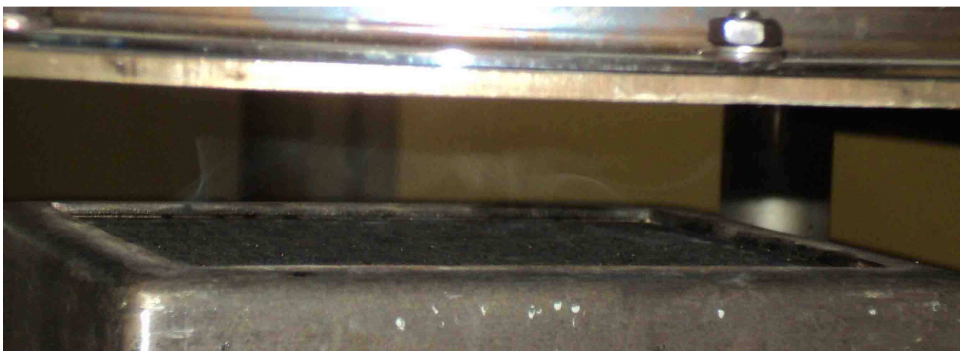
Figure 91 : photo de l'échantillon à t = 500\text{s} , en cône calorimètre à 50 \text{ kW.m}^{-2} .
