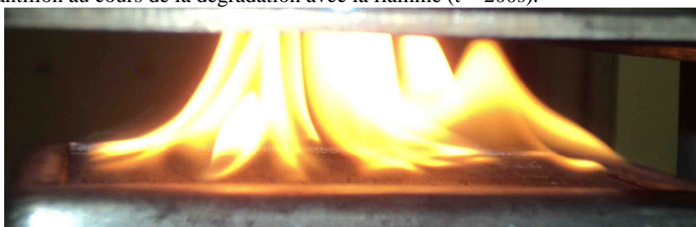
Figure 113 : photo du bois M3 en cône calorimètre à t = 200s à 50 kW.m -2
