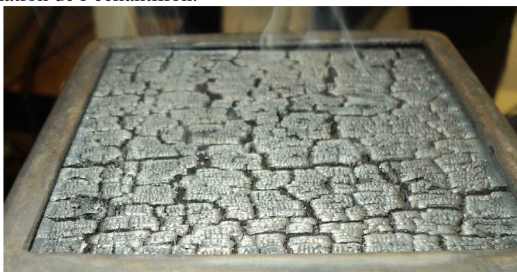
Figure 93 : Photo de l'échantillon à t = 900s en cône calorimètre à 50 \text{ kW.m}^{-2}
