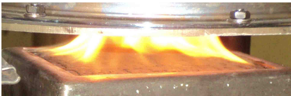
Figure 92 : photo de l'échantillon à t = 700s , en cône calorimètre à 50 \text{ kW.m}^{-2} .
