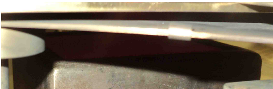
Figure 88 : photo de l'échantillon M1 initial à t=0\text{s} en cône calorimètre à 50 \text{ kW.m}^{-2}
