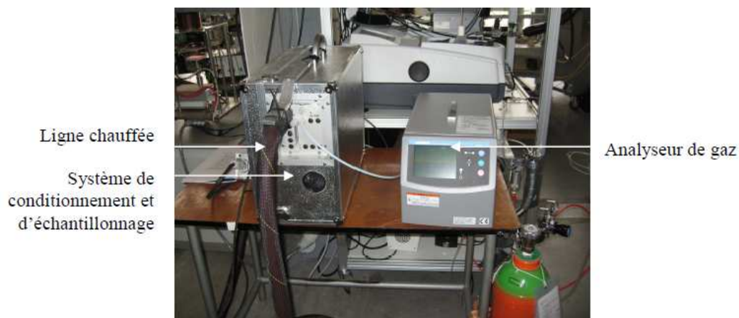
Figure 76 : photographie de l'analyseur de gaz HORIBA et de son échantillonneur.
