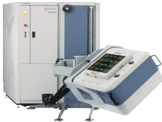
Figure 2.24. Testeur industriel Verigy V93K.
