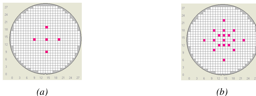
Figure 4.4 : schéma des puces mesurées au SEM pour la plaquette : exposée à condition nominale pleine plaquette (a) et exposée avec variation de dose et defocus (b)
