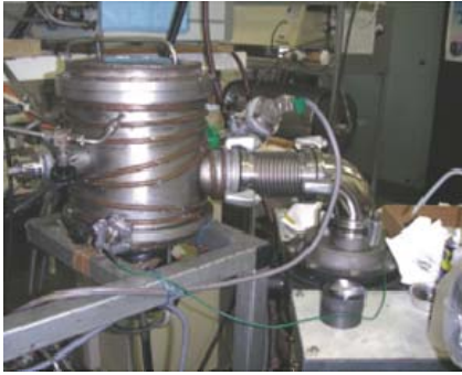
Figure 4.27 : Montage de compression à chaud utilisé dans cette étude [213]
