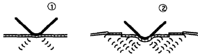
Figure 1-4. : Représentation schématique de la nucléation de dislocations à l'extrémité d'un indenteur en diamant (1) nucléation en volume, (2) rupture de la couche d'oxyde (Gerberich et al. 1996) [41].
