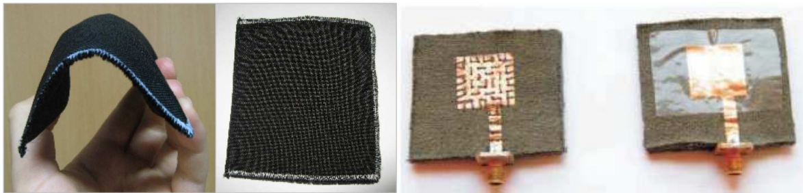
Figure 3.1 : Intégration de patches dans les vêtements, à gauche un patch à polarisation circulaire [ESA01] et à droite un patch classique [MAL01].
