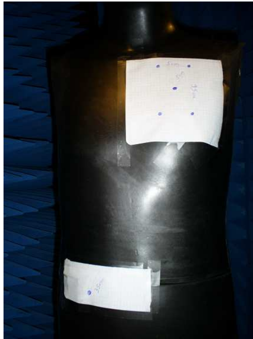
Figure 3.59 : Fantôme avec repères pour la mesure du bilan de liaison statique entre antennes
