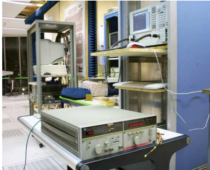
Figure 2.49 : Générateur SHF (en bas) et VNA Agilent (en haut à droite)
