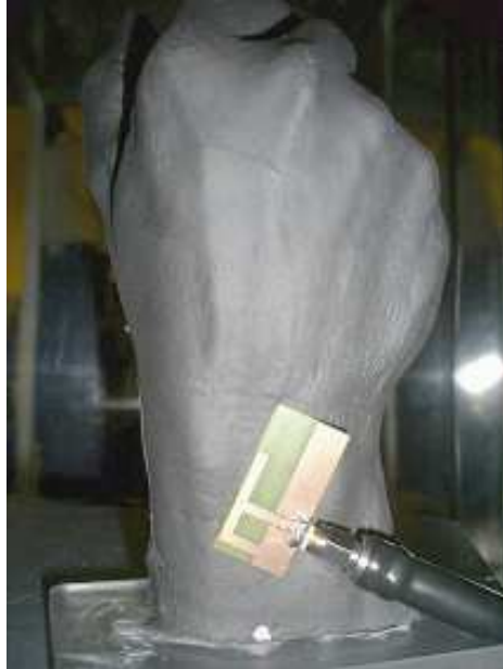
Figure 3.48 : Fantôme d'une main avec une antenne IIFA
