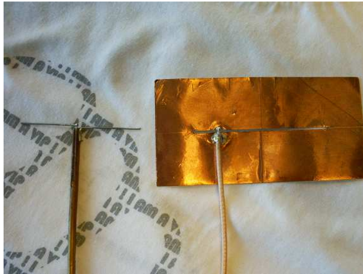
Figure 3.18 : Dipôle demi-onde et prototype d'une fente demi-onde intégrée sur un T-shirt
