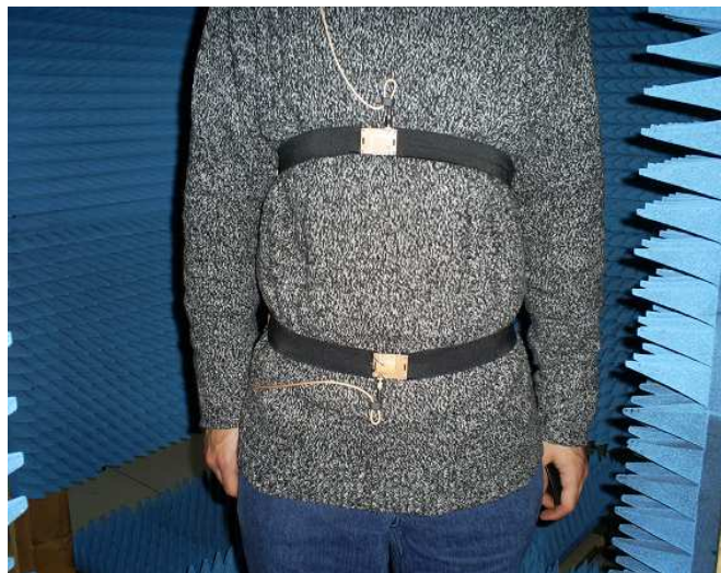
Figure 2.54 : Configuration des antennes pour le trajet torse-torse
