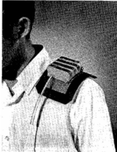
Figure 1.3. Prototype d'antenne magnétique VHF portée sur le corps (1974), [KIN02]
