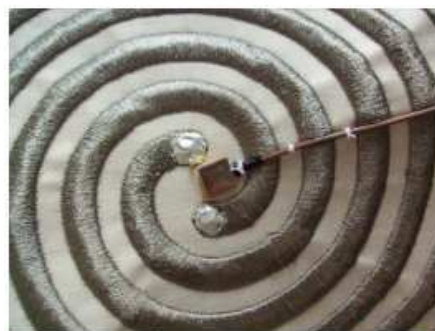
Figure 3.2 : « Wearable antenna » cousue sur un tissu [MAT01]
