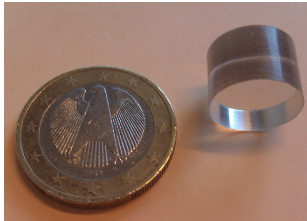
FIG. III.4 – Photographie d'un grain photoélastique de forme cylindrique d'épaisseur L = 9.4 mm et de diamètre d_1 = 13 mm.
