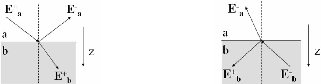
Fig. 2.6 : Réflexion et transmission au niveau de l'interface entre deux milieux d'indices différents, (a) le faisceau vient du milieu a, (b) le faisceau lumineux vient du milieu b.
