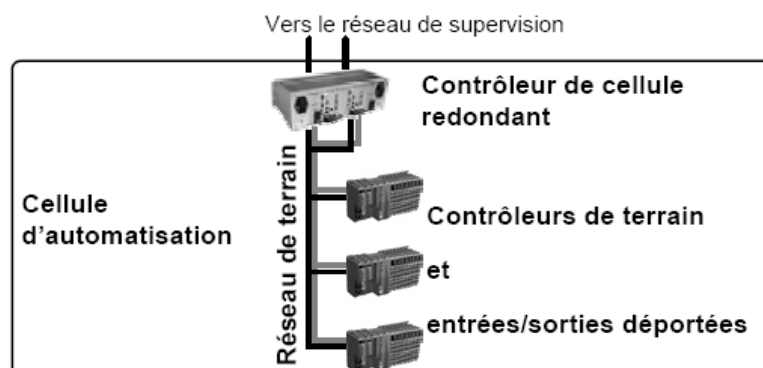
Fig. 1.3 : Cellule d'automatisation ou SCR (Limal, 2009)
