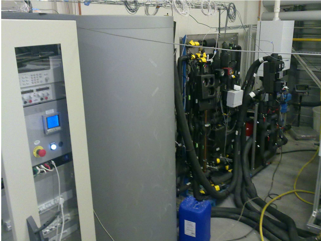
Figure 4-11 Photo du SSCa installé sur le banc d'essai thermique semi-virtuel
