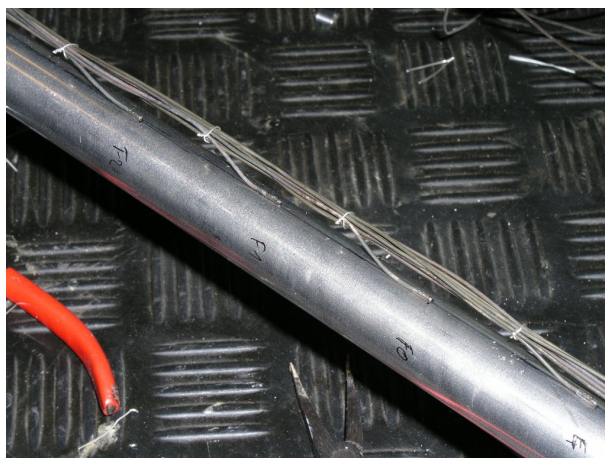
FIG. 4.5 – Thermocouples fixés sur la section d'essai
