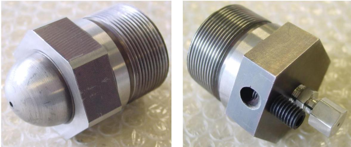
Figure III-9 : a) Nez de buse non instrumenté servant pour l'injection et
