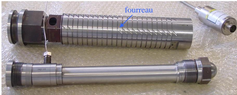
Figure III-7 : Photo du fourreau avec l'adaptateur
