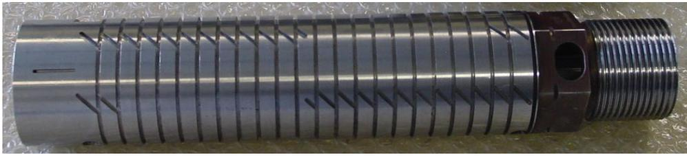
Figure III-10 : Fourreau où l'on frette les deux demi-cylindres
