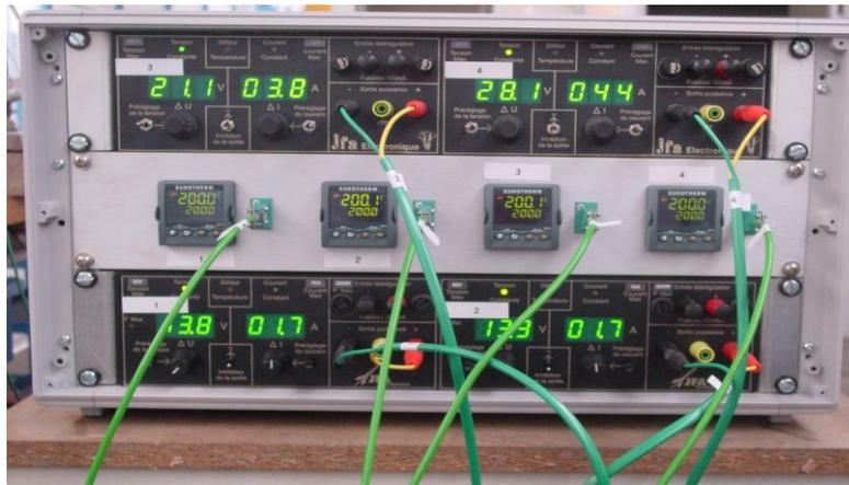
Figure III-13 : Alimentations des quatre zones de chauffe
