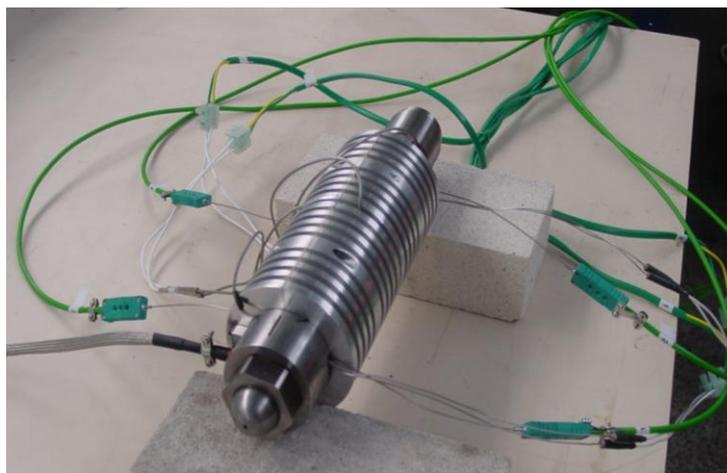
Figure III-28 : Vue de la buse avec l'instrumentation finie
