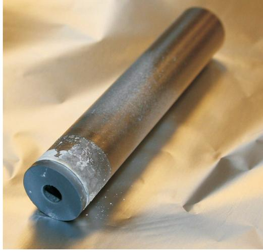
FIGURE 1.4 – Photographie de l'insert en zircone. Après 15 mois d'utilisation, le barreau de chrome à l'intérieur est entièrement consommé. La couleur gris métallisé provient du dépôt de chrome sur l'insert qui, lui, est plutôt de couleur beige-orange. La poudre blanchâtre provient de la colle haute température servant à maintenir le bouchon.
