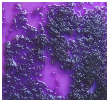
Figure 2-11 : Observation des cristaux formés lors du dépôt du gel sur une surface plane pour f=0,4 .
