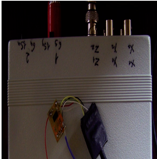
FIGURE 5.29 – Présentation de l'accéléromètre MMA7361L utilisé
