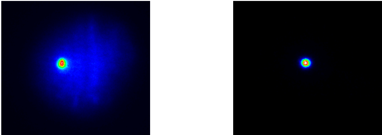
Figure 3-1-Images de la décharge en argon en mode normal face cathodique (à gauche) et face anodique (à droite)
