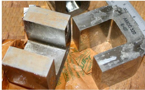
Figure I-15 : Noyaux amorphes de Metglas sous forme de U (PowerLite®)
