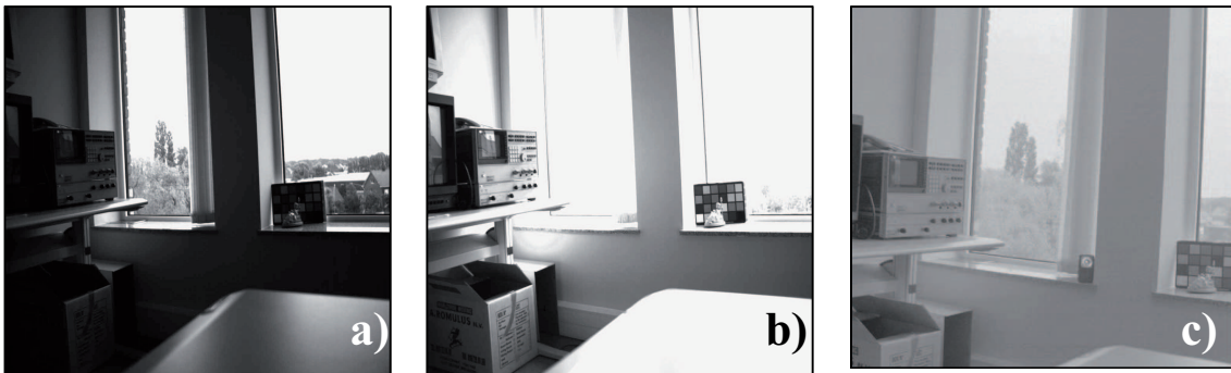
FIGURE 2.32 – a) Une dynamique de 60dB et un faible temps d'exposition, b) Une dynamique de 60dB et un long temps d'exposition, c) Une dynamique de 120dB (source Fillfactory)
