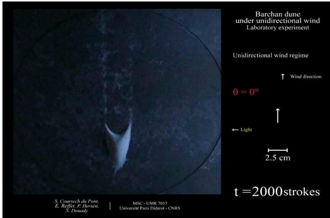
FIG. C.10: **Film 10** : Formation et migration d'une barchane sous un régime monodirectionnel de vent.
