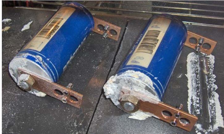
Figure 3. 6: Photographie des supercondensateurs P08 et P09 ayant fuit (avec leurs connectiques permettant la mesure 4 points) au cours du vieillissement calendaire
