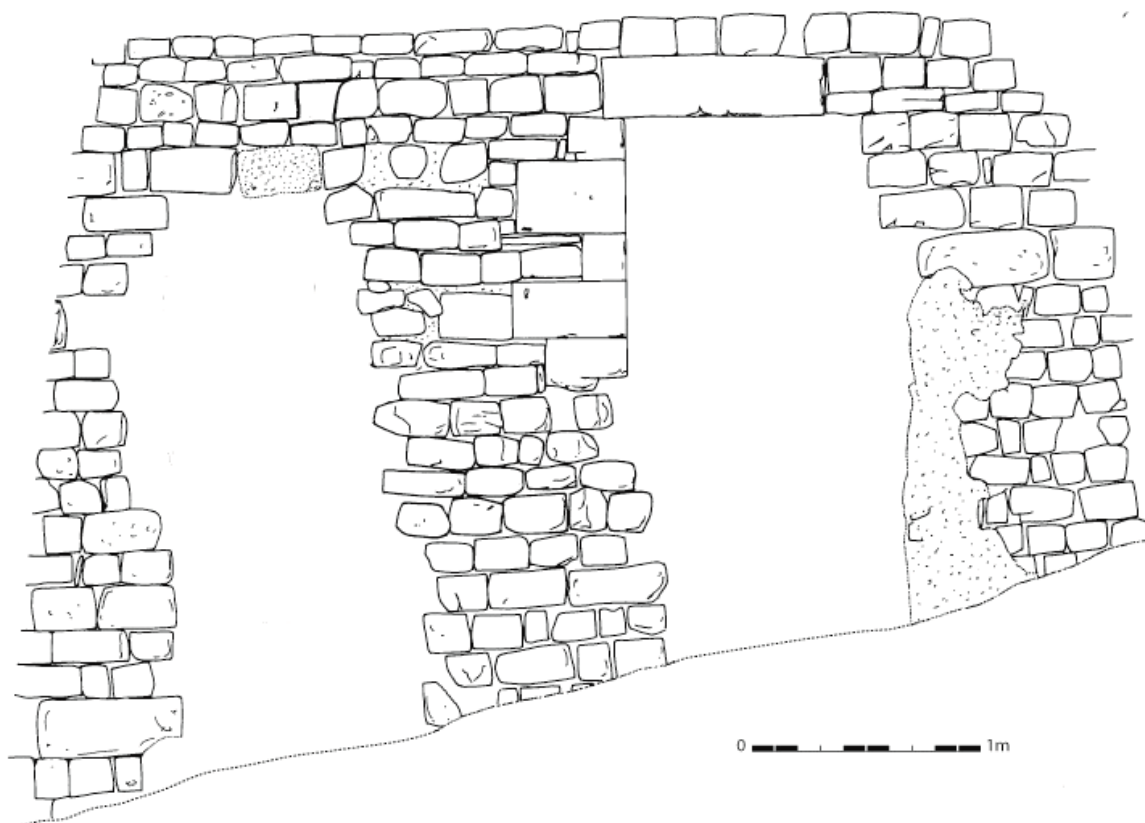
Fig. n° 76. Relevé de l'échantillon de la façade nord de la tour de l'évêque, avec les vestiges de l'archère (à droite) (relevé et D.A.O. : M. Varano).
