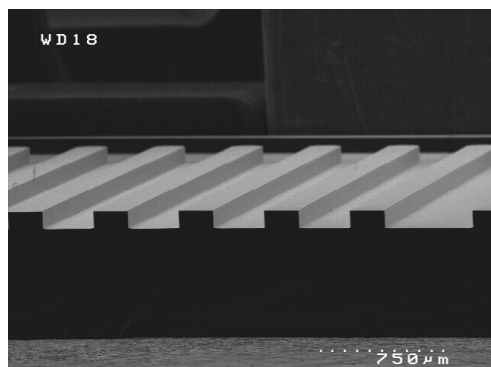
Figure III-54. Texturation observée au MEB
