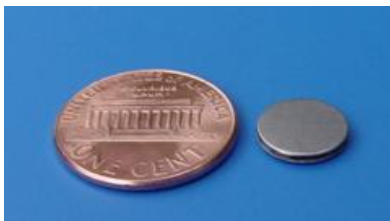
Figure I-7. Elément thermoélectrique [THE] (6 μW/°C)
