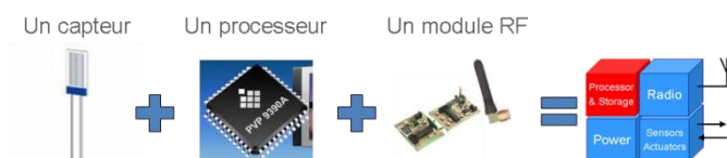
Figure 9. Eléments de base d'un nœud consommateur d'énergie
