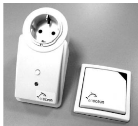
Figure I-33. Interrupteurs sans fil développés par EnOcean
