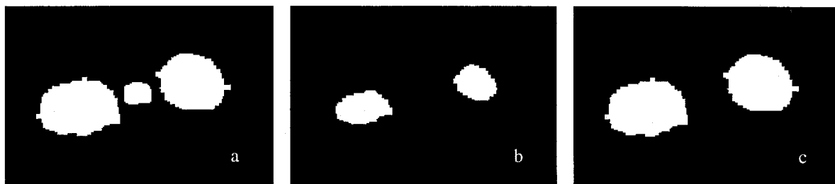
Figure 3 : Exemple d'érosion reconstruction, a : image d'origine, b : résultat de 7 érosions de taille 3x3, c :dilatation conditionnelle
