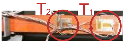
FIGURE 1.4 – Illustration de l'éprouvette et des deux montages de jauges en T notés T_1 et T_2 .
