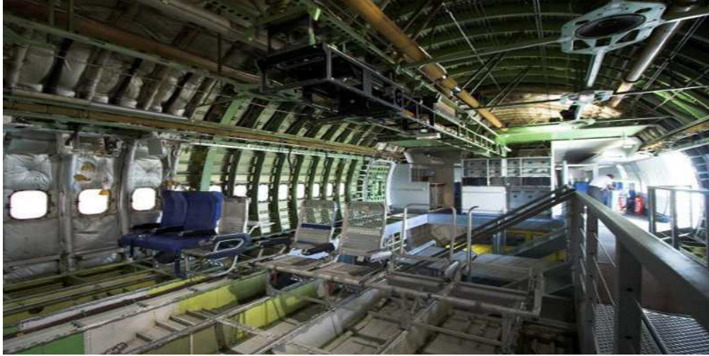
FIGURE 3.3 – Illustration d'un fuselage de boeing 747 composé de poutres courbes sous chargement multiple.
