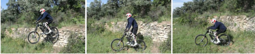
FIGURE 1.20 – Illustration d'une réception de saut d'un mur de 1,5m avec le VTT. L'amortissement du cycliste et le réglage des amortisseurs sont des éléments importants de la sollicitation du VTT.
