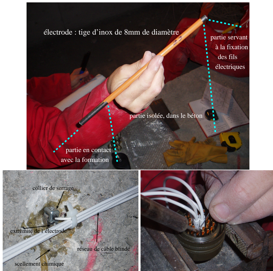
FIG. 6.8 – a) Photo d'une électrode implantée dans la galerie EZ-G (Juillet 2004). b) Mode de connexion des électrodes. c) Prise de connexion au résistivimètre.
