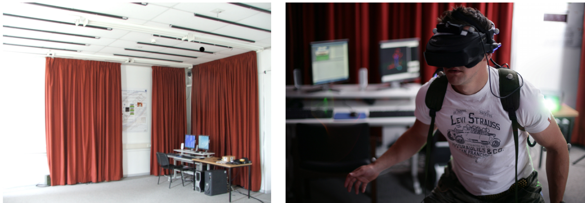
Figure 4.3 - A gauche : espace d'expérimentation possédant les capteurs intersense fixés au plafond. A droite : sujet équipé du HMD et de l'émetteur infrarouge intersense
