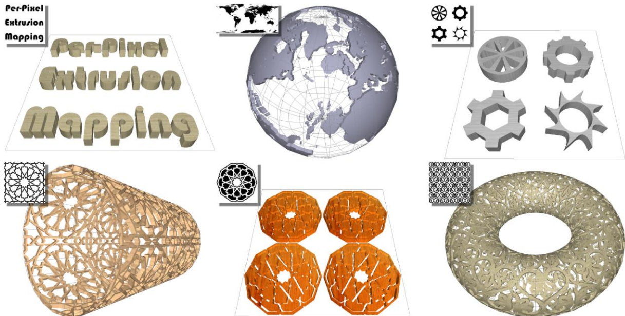
Fig. 4.20 - Quelques objets créés à l'aide du placage d'extrusion. Ces objets sont obtenus à partir d'un maillage de faible densité, sur lequel une carte de forme a été plaquée. La technique de placage d'extrusion permet de restituer une géométrie très détaillée, évitant ainsi de recourir à un maillage beaucoup plus dense.
