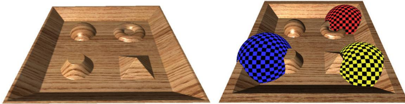
Fig. 2.11 - Technique du placage de relief [POC05]. L'image de gauche met en évidence l'interpénétration avec d'autres objets de la scène.
