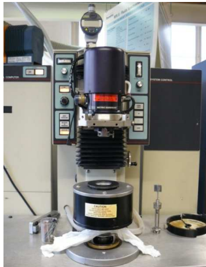
Figure II-8 : Rhéomètre RSF II permettant la caractérisation des mortiers adjuvés.
