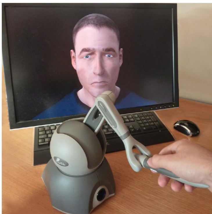
Figure 102 - Bras haptique Phantom OMNI (SensAble) pour l'interaction avec MARC
